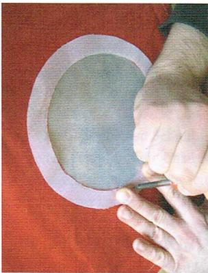
Legt die Gaze von links auf das Loch für die Lufteintrittsöffnung, sodass der Ring aus Spinnaker nach oben zeigt, und verwendet einen spitzen LötKolben, um die Gaze auf dem Kappenteil zu fixieren. Näht die Gaze anschließend an der Ringinnenseite mit einem Zickzackstich fest.
